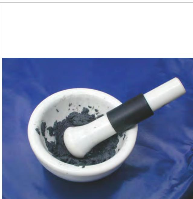
Figura 5 - Con un mortaio, pestate della carta di giornale fino ad ottenere una pasta omogenea in cui le fibre siano isolate
